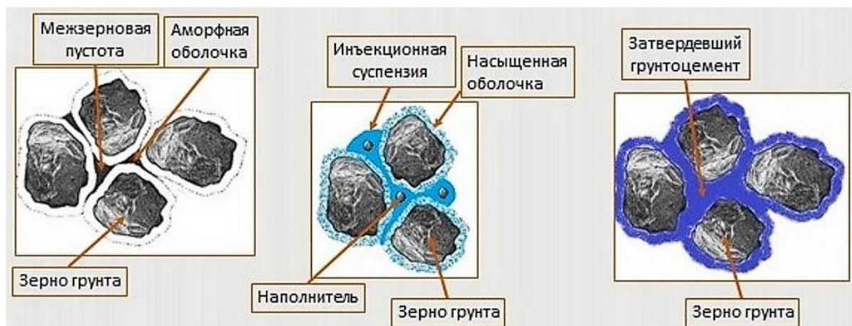
Рисунок 1 - Физическая модель грунтового массива, инъекционно закрепляемого суспензиями тонкодисперсных вяжущих
