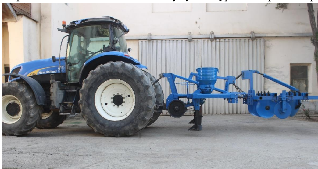
2-расм. Ток қаторлари ораларига ишлов берадиган машина
