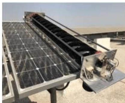
1-rasm. O‘zini-o‘zi tozalovchi va poylash tizimiga ega quyosh fotoelektrik stansiyasi.
