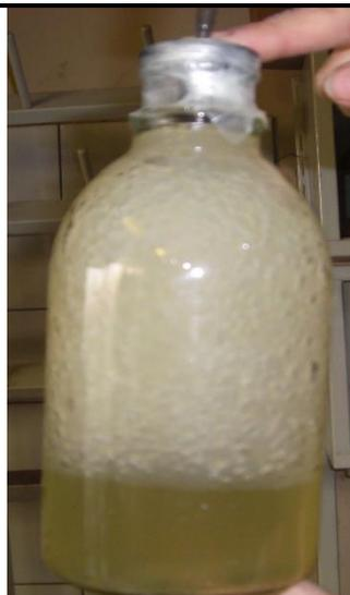
Рис.1. Опытный образец выделения биогаза из навоза свиней
