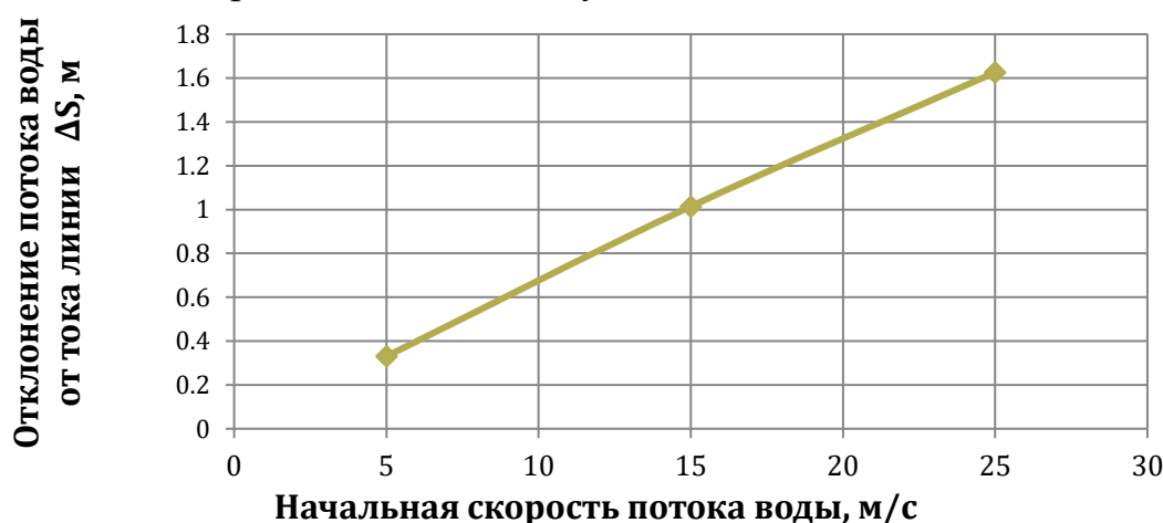
Рис. 2. Отклонения \Delta S потока воды от линии тока в зависимости от начальной скорости струя: \varphi = [180]^\circ , \psi = 6^\circ , [94]^\circ , R = 0,5 м, Re = 154696,13 , \alpha = [15]^\circ , l_2 = [0,454807 \text{ м}] и d = 2 мм
