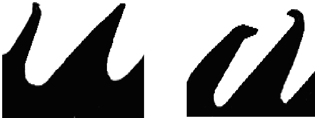
1-расм. Оғир аралашмалар ва металл жисмлар таъсирида жин арасининг шикастланиши кўрсатилган
